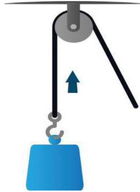
Gambar 3.8 Katrol, alat yang mempermudah pekerjaan manusia
