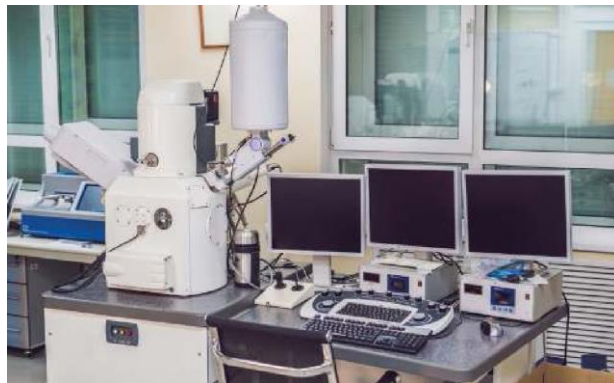
Gambar 1.7 Mikroskop elektron yang digunakan di laboratorium.
