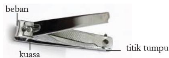
Gambar 3.14 Pemotong kuku, contoh pengungkit jenis 3
