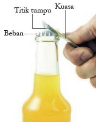
Gambar 3.15 Alat pembuka botol, contoh pengungkit jenis 2
